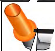
Lors de l'insertion du support de porte de sécurité, assurez-vous qu'il est correctement positionné dans la fente de positionnement
