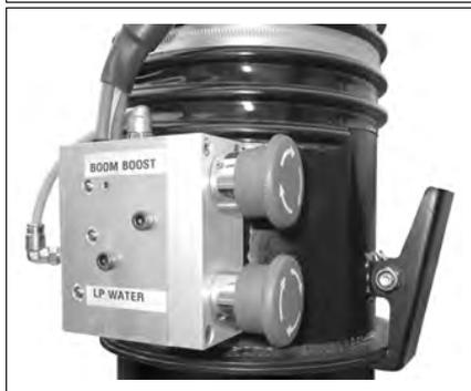
**Commandes de la potence mobile supérieure en option** - Celles-ci sont montées juste au-dessus de la poignée du bras mobile et sont constituées de deux boutons de sélection de la vitesse du booster supplémentaire du ventilateur (3ème vitesse) à environ 2500 tr/min et/ou l'alimentation d'eau de suppression de poussière basse pression. La vitesse du moteur augmentera automatiquement à 1800 tr/min lorsque la 3ème vitesse de turbine sera sélectionnée.
