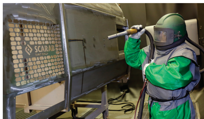
Sabbiatura della tramoggia in acciaio inossidabile
