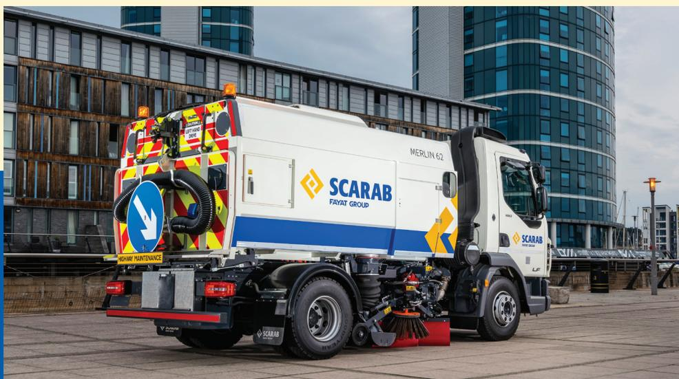
Die Merlin 62 ist nur eine von Scarabs fachmännisch konstruierten, auf LKWs montierten Straßenkehrmaschinen. Aufgrund ihrer Flexibilität kann die Merlin 62 auf eine große Auswahl an Fahrgestellen montiert werden, darunter solche von DAF, Iveco, MAN, Mercedes, Volvo, Renault, Hino und anderen Herstellern. Weitere Informationen zu den geeigneten Fahrgestellspezifikationen erhalten Sie von Ihrem lokalen Vertriebspartner.
