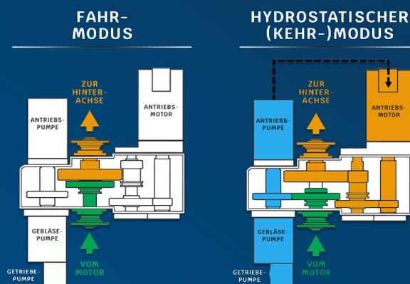
Unsere Unidrive-Lösung nutzt einen am Lkw-Motor angebrachten Nebenantrieb (PTO), um die Kehraktionen anzutreiben. Das Magnum 72-Steuerungssystem steuert die Motordrehzahl, um eine optimale Kehrleistung zu gewährleisten.
