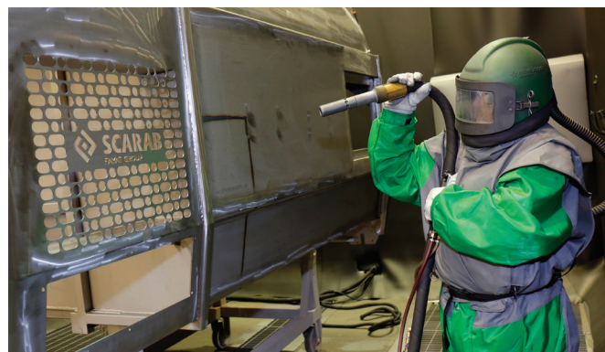
Kehrgutbehälter aus Edelstahl wird sandgestrahlt
