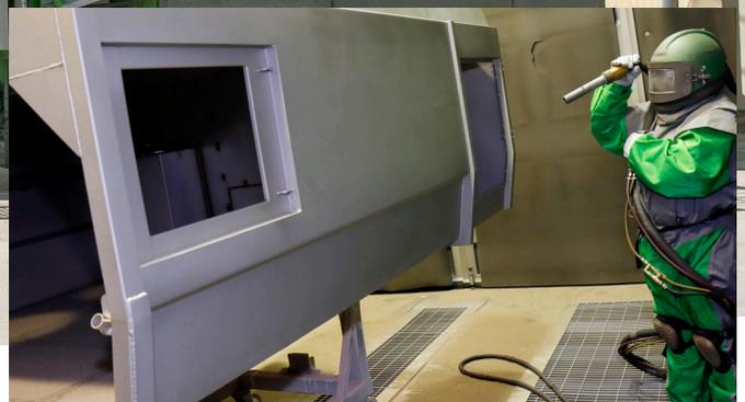
Gehäuse des Kehrgutbehälters aus Edelstahl wird sandgestrahlt
