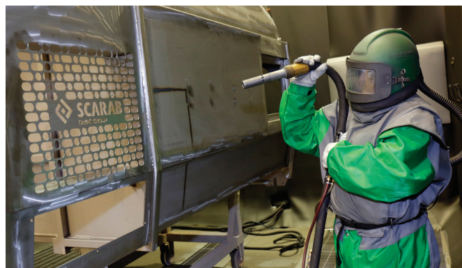
Sabbatura della tramoggia in acciaio inossidabile
