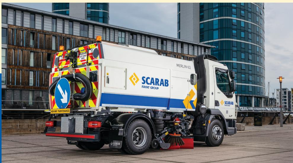
Merlin 62 è una delle soluzioni di spazzamento stradale su camion progettate dalla Scarab. Grazie alla flessibilità del prodotto, è possibile montare Merlin 62 su un'ampia gamma di telai, compresi quelli DAF, Iveco, MAN, Mercedes, Volvo, Renault, Hino e altri. Per i dettagli delle specifiche dei telai compatibili, contattare un distributore locale.
