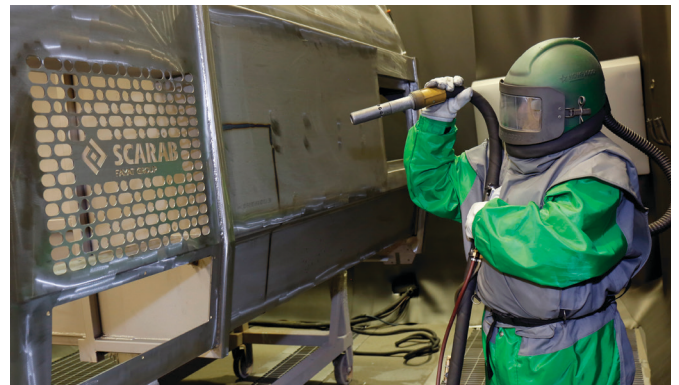
Kehrgutbehälter aus Edelstahl wird sandgestrahlt
