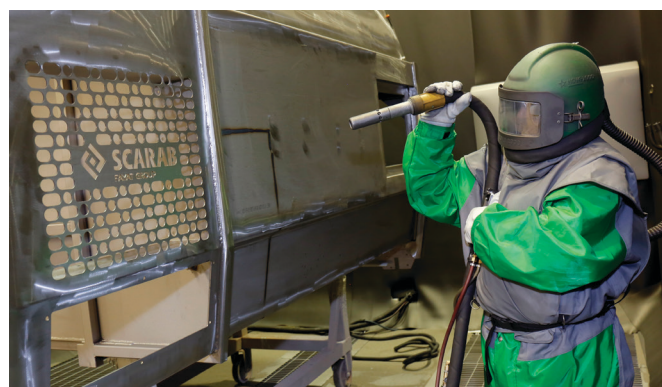
Grenailage de la trémie en acier inoxydable
