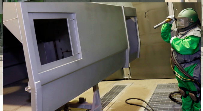
Gehäuse des Kehrgutbehälters aus Edelstahl wird sandgestrahlt
