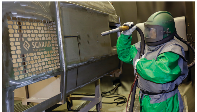
Kehrgutbehälter aus Edelstahl wird sandgestrahlt
