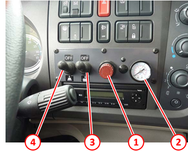
Controles del cepillo lateral montados en la cabina
