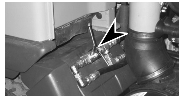
VANNE DE COMMANDE DE LA RAMPE DE PULVÉRISATION HP 'OFF'
